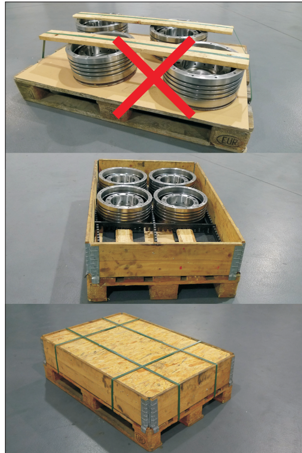
Oben: Die Kolben sind ungenügend gesichert. Mitte: Sicherheit mit Steckleisten, unterlegten Anti-Rutschmatten und formschlüssig gesetzten Brettern. Unten: Die Kiste ist bereit: Deckel und Verspannung sichern die Ladung auf dem genormten Euro-Palett vollumfänglich ab.
